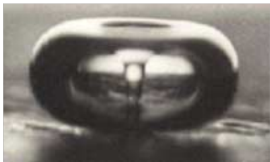
Bild 5: Ausbildung eines Flüssigkeitsstrahls. Kollabiert eine Blase in der Nähe von festen Oberflächen, entstehen so genannte Flüssigkeitsjets, die durch die Blasen hindurch hin zur festen Oberfläche schießen und diese zusätzlich reinigen (Foto: L. A. Crum, Applied Physics Laboratory, University of Washington).
