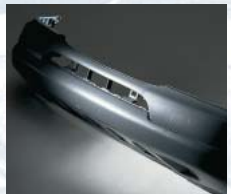
Ultraschall-Nieten von Stoßfängern aus PP
