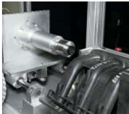
Rotationsreibschweißen an einer Sauganlage für PKW-Motoren
