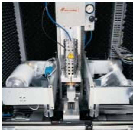
Ultraschall-Standardanlage, Typ Omega, zum Schweißen von Funktelefonen, mit Werkstückträger-Transportband und automatischer Folien-Abwickleinrichtung.
