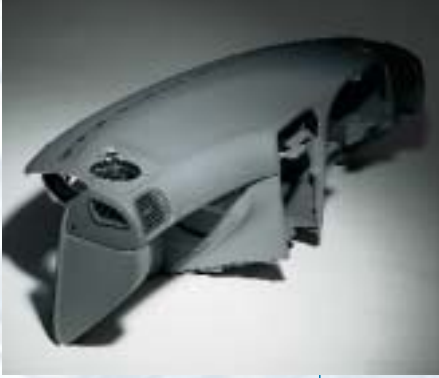
Verschweißen von Luftkanälen in eine Instrumententafel aus PP
