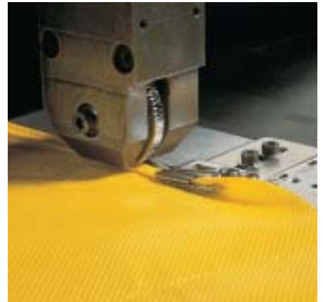
Kontinuierliches Schweißen von Kunststoff-Folien und -Gewebe mit Ultraschall
