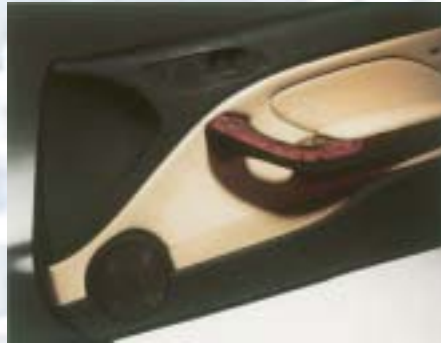
Ultraschall-Nieten Türinnenverkleidung mit hochwertiger Stoff- bzw. Lederkaschierung
