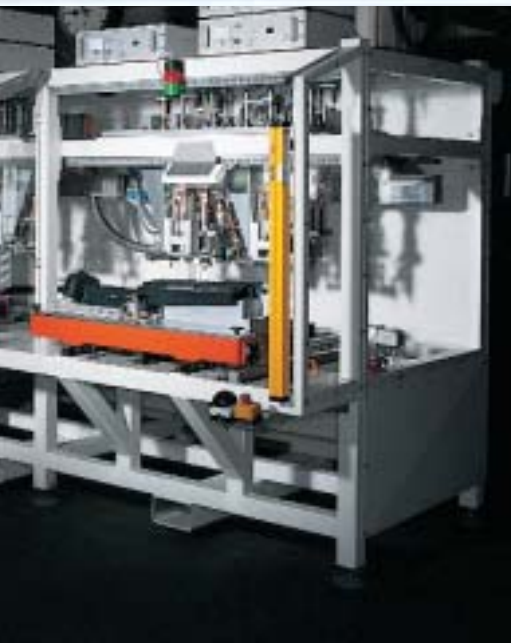
Ultraschall-Mehrkopfanlagen zur Herstellung von verschiedenen Verkleidungs-, Verstärkungs- und Funktionsteilen wie z. B. Mittelkonsolen, Luftverteiler, Instrumententafel, Handschuhkastendeckel ...
