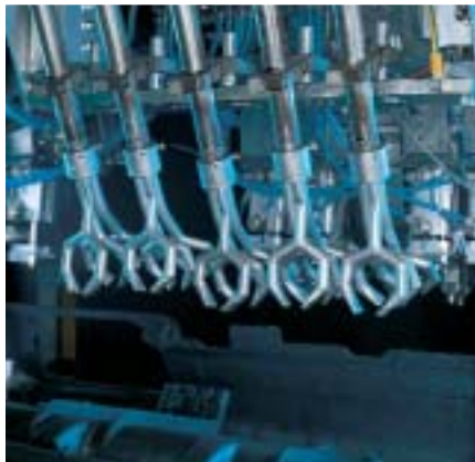
Sonderanlage zum thermischen Nieten eines Airbagblechs in eine KFZ-Instrumententafel
