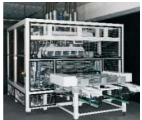
Sonderanlage zum Verschweißen von Kunststoff-Paletten. Die Bestückung der Anlage erfolgt vollautomatisch über Transferband, das Auflegen der aufzuschweißenden Abdeckungen über Handlingsystem. Die Anlage verfügt über eine integrierte Frässtation zur mechanischen Bearbeitung der Paletten.
