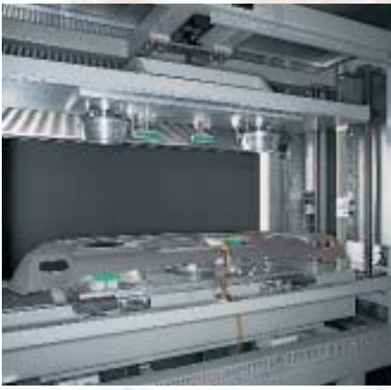
Vibrations-Schweißmaschine LVW 2067B zum linearen Verschweißen von Teilen bis zu einer Größe von 1.400 x 600 mm – z. B. Hutablage
