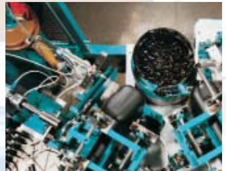
Sonderanlage für die Komplettierung von Kraftstofftanks mit automatischer Teilezuführung.
