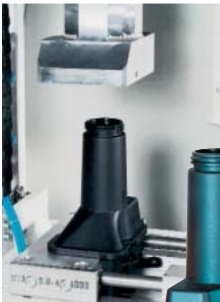
Rotationsreibschweißen an einer Sauganlage für PKW-Motoren
